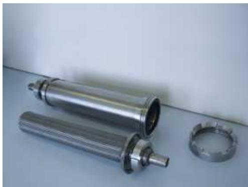
Многоходовые фильтры ФМ-03М предназначены для очистки различных жидкостей (в т.ч. высоковязких) от механических загрязнений (примесей).
