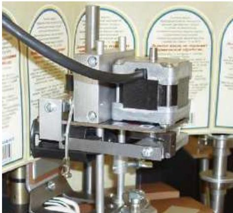
Принтер для этикеток ПЭШТ предназначен для нанесения переменной информации (даты выпуска, срока годности и т.п.) на бумажные, картонные или полимерные этикетки.
