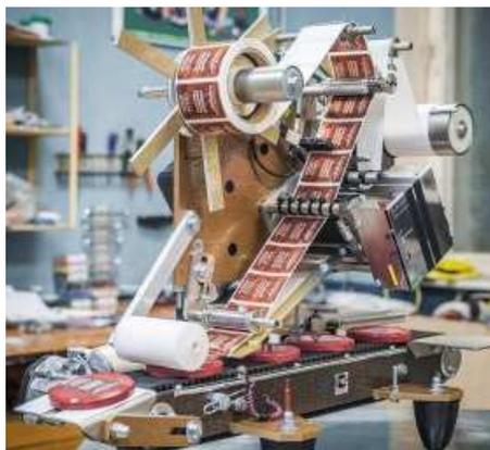
**Этикетировочная машина предназначена для нанесения самоклеящихся этикеток на различную тару сверху.**
