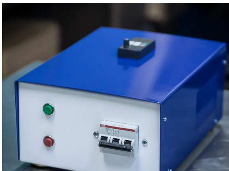
**Блоки ПЧ предназначены для регулировки скорости вращения двигателей дозаторов УД-2 и УД-2П, установок УПЭСм и насосов-гомогенизаторов НГД.**
