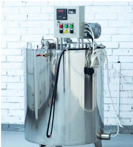
Емкости могут быть пластиковыми или из нержавеющей стали. Иметь одну, или несколько стенок (чаще всего используются одно- или двухстенные емкости). Емкости могут быть оснащены различными элементами для проведения необходимых технологических процессов.
